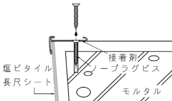
※ 両端約50mm(100mm以内)、中約300mmピッチ(2~3ヶ穴をとばす)で穴明して下さい。
